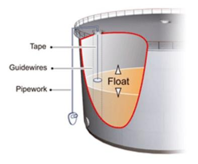
GROUND READING TANK LEVEL INDICATOR Fig. 13 **I**25
